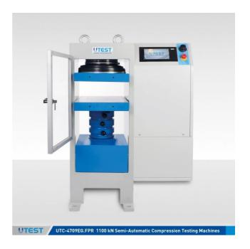
Машины состоят из сварной стальной рамы и автоматического гидравлического блока питания UTC-4830FPR с блоком управления U-Touch PRO. Рамы поставляются вместе с доборами Ø 205 мм высотой 100 мм, 50 мм и 30 мм.
