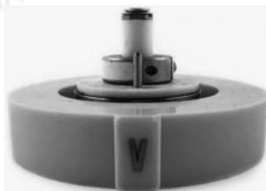
Рисунок 6 — Кольцо устройства для растрескивания битумного вяжущего в сборе с силиконовой формой
