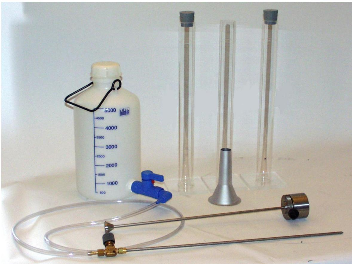
Предназначен для определения мелких частиц в грунтах и каменном материале. Состоит из:
