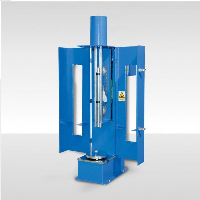
Уплотнитель может работать с формами типа А (диаметр 100 мм) и типа В (диаметр 150 мм) по ГОСТ Р 70456-2022 и грузом типа А (масса 4,5 кг). Высота падения груза 457 мм.
