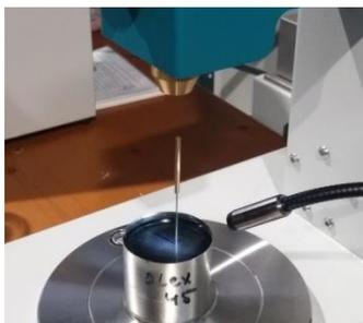
Автоматизированный пенетрометр автоматически освобождает иглу по завершению испытания и возвращается в исходное положение, соответствующее началу нового испытания, тем самым, не допуская повреждения иглы, погруженной в битумную пробу, а также исключая подъем битумной чашки вместе с иглой.
