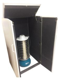
Звукозащитный шкаф изготовлен из современных материалов, предназначен для уменьшения шумового воздействия в лаборатории от автоматических устройств рассева при проведении ситового анализа, уменьшает выбросы пыли. Оборудован откидной крышкой с фиксаторами и двустворчатой дверцей, поставляется в разобранном виде (требует сборки на месте). Подходит для большинства современных виброгрохотов для сит диаметром 200-300 мм. Возможно изготовление моделей других размеров по чертежам заказчика.
