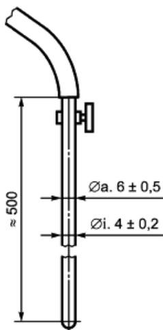
Рисунок 2 - Промывная трубка
