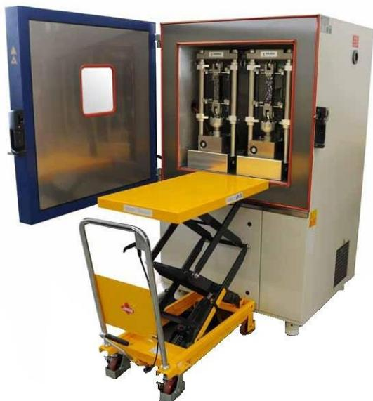
Установка представляет собой климатическую камеру, с испытательным стендом - разрушающим устройством, и предназначена для исследования поведения асфальтобетона под воздействием температуры.
